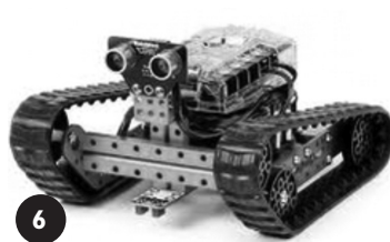
Figura 4: Robot Educatiu basat amb el controlador Crumble, amb sensor de distància. Robot enfocat per l'ensenyament de la robòtica a primària i als primers cursos de secundària. Està fabricat per 4tronix. Font : 4tronix (4tronix.co.uk).
